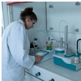
Mesure de la teneur en eau dans une graisse ou une huile (COFRAC) par four coulométrique
