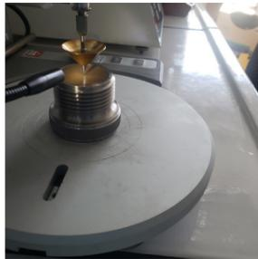
Mesure de la pénétrabilité travaillée ou non à température ambiante ou basse température d'une graisse (COFRAC)
