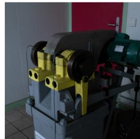
Évaluation des performances et du pouvoir lubrifiant à haute température d'une graisse au banc R2F
