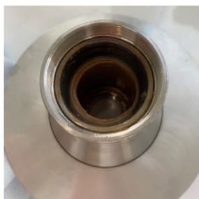
Mesure du ressuage dynamique d'une graisse (COFRAC)
