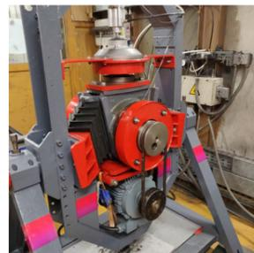
Mesure de la tenue aux chocs et vibrations des graisses aux bancs ROPECS et V2F
