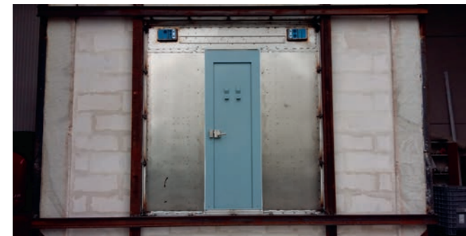
Face non exposée au feu d'une cloison séparant une cabine conducteur et un espace voyageur avant essai de résistance au feu.
