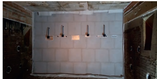
Face exposée au feu de boîtiers électroniques à usage ferroviaire avant essai de résistance au feu.
